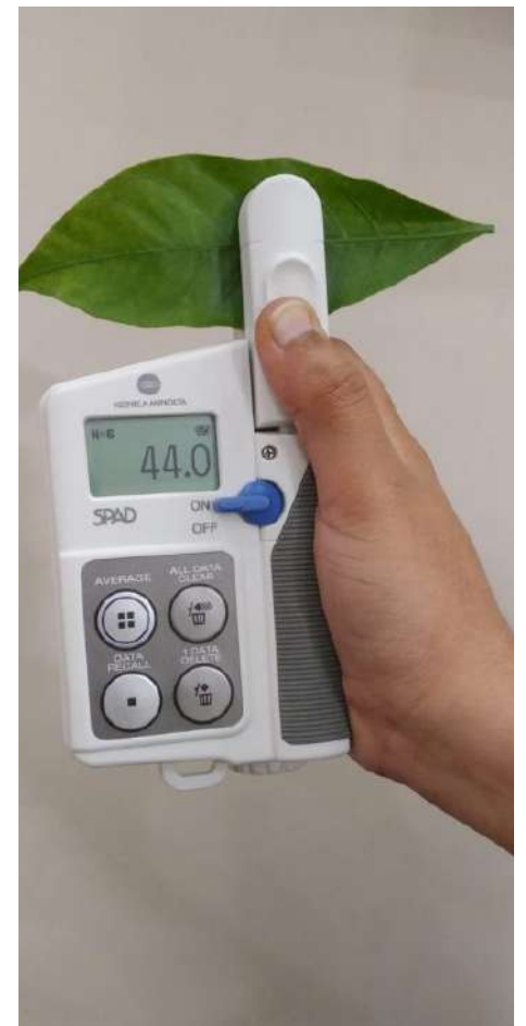
EL SPAD-502 mide la clorofila de la planta y posibilita determinar su nivel nutricional, desde que está en el semillero hasta la cosecha
