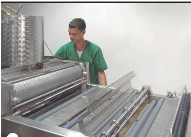
**LA MÁQUINA** de laminado de cera produce tres a la vez, hasta completar 15 cajas de 150 láminas cada una al día
