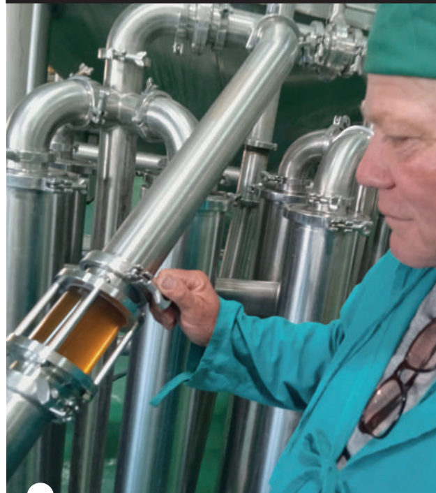
A TRAVÉS de filtros, las bombas impulsan la miel ya colada hacia el homogeneizador
