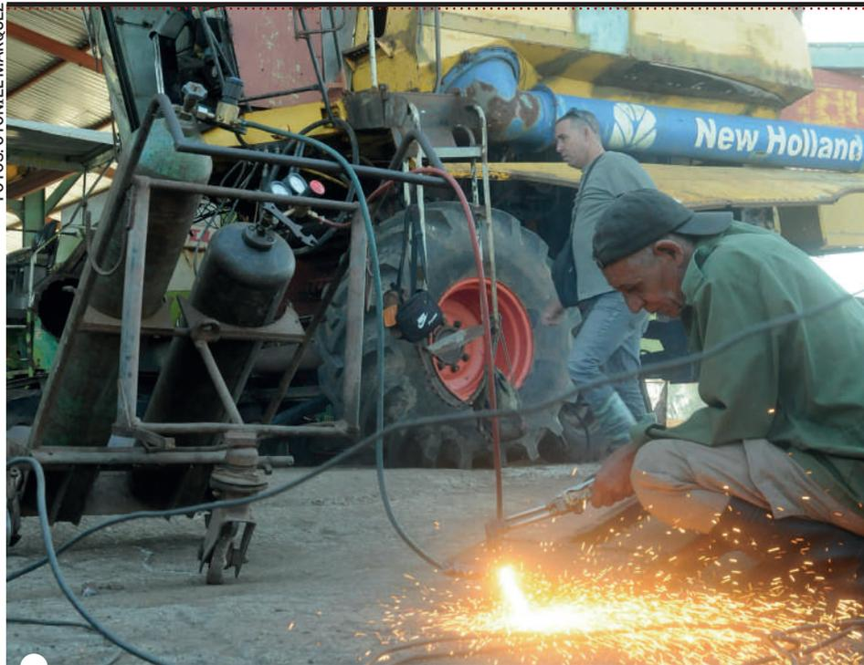
**ELECTRICISTAS, mecánicos y soldadores laboran en el mantenimiento y reparación de cosechadoras y tractores, de cara al inicio de la cosecha del arroz.**
