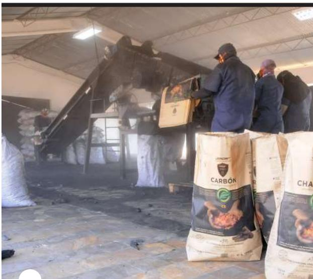
LA MÁQUINA beneficiadora de carbón está diseñada para seleccionar el producto por su calidad
